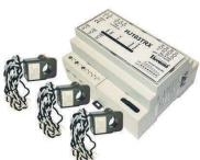
**HJ103TRX** (арт. 43518.1), реле разгрузки (ограничения тока). Реле контролирует эл. нагрузку на весь дом (квартиру) и в случае превышения эл. тока снижает мощность любого электрокотла THERM EL.
