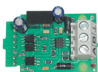
**REKAS 1** (арт. 42188) - Интерфейс для каскадного подключения до 32 электрокотлов THERM EL. В каждом котле используется один интерфейс, отдельные интерфейсы подключаются параллельно, 3-х жильным проводом. Все параметры и данные устанавливаются только на одном, ведущем котле, а остальные, ведомые котлы каскада работают по информации, выдаваемой ведущим котлом.
