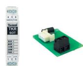
**SADA TKR SOT** (арт. 42054) - Комплект расширения на один котел SADA TKR SOT – содержит не только дополнительный модуль к регулятору, но и блок коммуникации с котлом. При установке в TKR BOX или в TKR BOX II, достаточно установить модуль SOT на DIN-рейку, которая уже оснащена шиной соединения с регулятором THERM TKR, тем самым произойдет автоматическая коммутация с регулятором.
